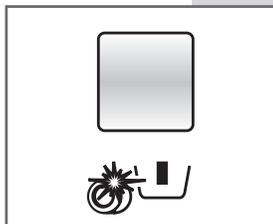
**TURBO** : presser la touche Turbo **E** pour réduire la durée du lavage. Les paramètres de fonctionnement sont automatiquement réglés de manière à garantir un lavage efficace tout en réduisant sa durée. Consulter le tableau des programmes pour plus d'informations.
