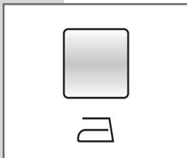
**EASY IRON:** Activando la opción Easy Iron mediante el pulsador **G**, la lavadora regula los parámetros de lavado para disminuir la formación de pliegues facilitando las operaciones de planchado. La velocidad de centrifuga es implementada automáticamente a 500 rev./min.
