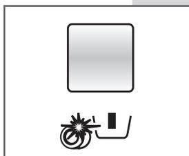
**TURBO:** Stláčením tlačidla Turbo E sa skrúti doba prania. Parametre činnosti sa upravujú automaticky, aby bola zaručená účinnosť prania a aby sa umožnila úspora času. Podrobnejšie informácie si vyhľadajte v Tabuľke programov.
