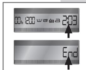
**ЗАДЕРЖКА ПУСКА** Данная функция позволяет отложить начало цикла стирки максимум на 16 часов. Нажмите несколько раз кнопку **B**, пока на дисплее не появится нужное время задержки пуска. На дисплее мигает символ h до тех пор, пока не начнется цикл стирки.
