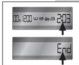
**POSUNUTÝ ŠTART:** Táto funkcia umožňuje posunúť spustenie cyklu prania až o maximálne 16 hodín. Opakovane stláčajte tlačidlo B, kým sa na displeji nezobrazí želaná doba posunutia štartu. Ikona h bude blikať na displeji, až kým sa nespustí cyklus prania.
