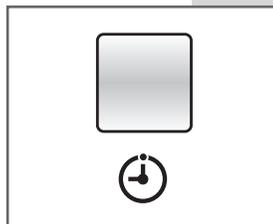
**CENTRÍFUGA REGULABLE:** Presionando el pulsador **C** la velocidad de centrifuga puede regularse en función del programa de lavado seleccionado y del tipo de tejidos. En el display LCD se ilustrará el valor de velocidad seleccionado. Para excluir la centrifuga al final del ciclo seleccionar el valor "00".
