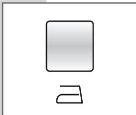
**EASY IRON:** Aktivací funkce Easy Iron pomocí tlačítka **G** pračka seřídí prací parametry tak, aby se prádlo méně mačkalo, čímž se usnadní žehlení. Rychlost odstředování se nastaví automaticky na 500 otáček/min.
