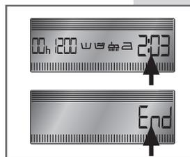
**UITGESTELDE START:** met deze functie kan de start van de wascyclus tot maximaal 16 uur worden uitgesteld. Druk herhaaldelijk op de knop **B** totdat de gewenste uitgestelde starttijd op het display wordt weergegeven. Het pictogram **h** knippert op het display totdat de wascyclus wordt gestart.
