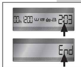
**ARRANQUE DIFERIDO:** Esta função permite adiar o arranque do ciclo de lavagem até um máximo de 16 horas. Prima várias vezes o botão B até aparecer indicado no display o tempo de adiamento do arranque desejado. O ícone **h** piscará no display até ao momento do arranque do ciclo de lavagem.
