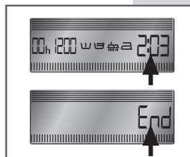
**KÉSLELTETETT INDÍTÁS:** Ezzel a funkcióval maximum 16 órával késleltethető a mosási ciklus elindítása. Addig ismételje a **B** gomb megnyomását, amíg a kijelzőn meg nem jelenik a kívánt késleltetési idő. A ciklus elindulásáig a kijelzőn h ikon villog.
