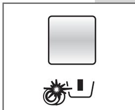
**TURBO:** Apăsăți pe butonul Turbo **E** pentru a micșora durata spălării. Parametrii de funcționare se reglează automat pentru a asigura eficiența la spălare și pentru a permite o economisire a timpului. A se vedea Tabelul cu Programe pentru alte informații.
