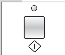
**ПУСК:** На етапі вибору програм та функцій прання індикатор «Start» («Пуск») буде блимати. Для підтвердження вибору та запуску циклу прання натисніть кнопку **H**. При цьому індикатор загориться.
