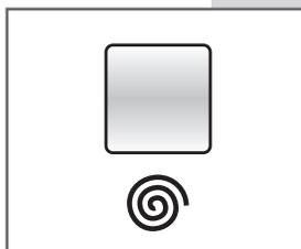
**PRELAVADO:** Para efectuar el Prelavado presionar el pulsador **D** y añadir el detergente en la cubeta específica **1**. La lavadora efectúa un Prelavado a 40°C máx. El prelavado es indicado en caso de ropa sucia con polvo, con tierra, arena o en presencia de manchas particularmente resistentes. Ver la tabla de programas para mayores informaciones.
