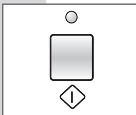
**ĮJUNGIMAS.** Programos ir skalbimo pasirinkčių pasirinkimo metu blykčios įjungimo indikatorius. Kad patvirtintumėte pasirinkimus ir skalbimo ciklo pradžią, paspauskite „Start“ (įjungimo) mygtuką **H**. Užsidegs atitinkamas indikatorius.
