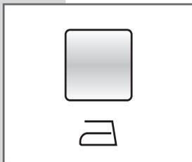
**EASY LOGIC:** Aktiváciou voliteľnej funkcie prostredníctvom tlačidla G práčka upraví parametre prania, aby sa znížilo pokrčenie bielizne a uľahčilo sa nasledovné žehlenie. Rýchlosť odstreďovania sa automaticky nastaví na 500 otáčok/min.
