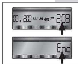
**STARTVERZÖGERUNG:** Mit dieser Taste kann der Start des Waschgangs um bis maximal 16 Stunden verzögert werden. Die Taste **B** mehrmals drücken, bis am Display die gewünschte Verzögerungszeit sichtbar wird. Das Symbol **h** blinkt am Display, bis der Waschgang angelaufen ist.
